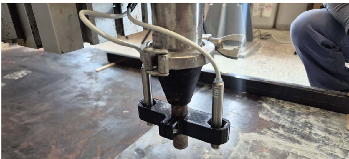
Obrázek 25: Teplotní senzory umístěné na tiskové hlavě.
