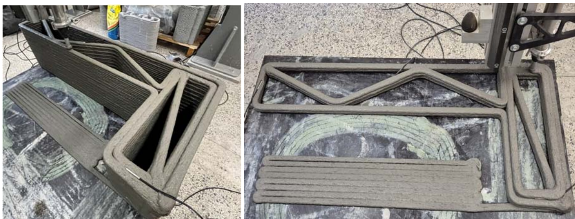
Obrázek 22: Zabudovaná teplotní čidla během tisku
