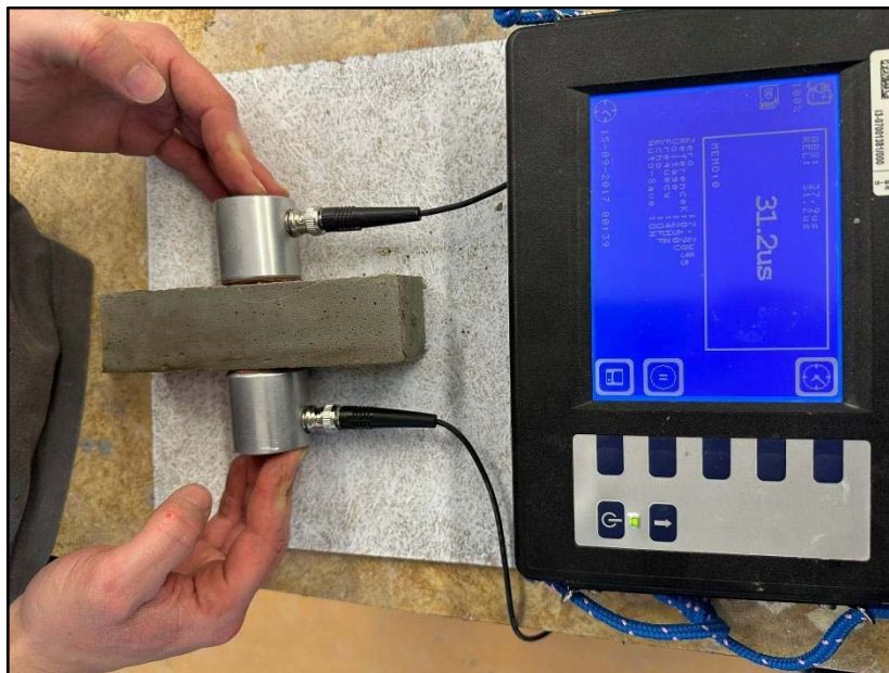
Obrázek 13: Stanovení rychlosti průchodu ultrazvukového signálu
